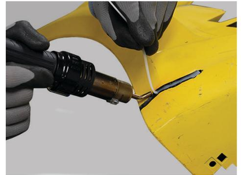
Use o soldador de ar quente para fazer soldas rápidas e fortes em termoplásticos com as hastes de fita incluídas.
