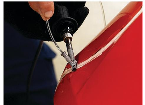
Use o soldador sem ar para alisar soldas feitas com ar quente ou para reparar para-choques e revestimentos de caçambas de poliuretano (PUR) termofixo com a haste de solda incluída.
